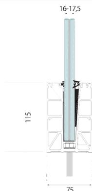
Le rail aluminium est anodisé. Il est seulement fixé au sol et est capable de tenir le verre en autoporté.
